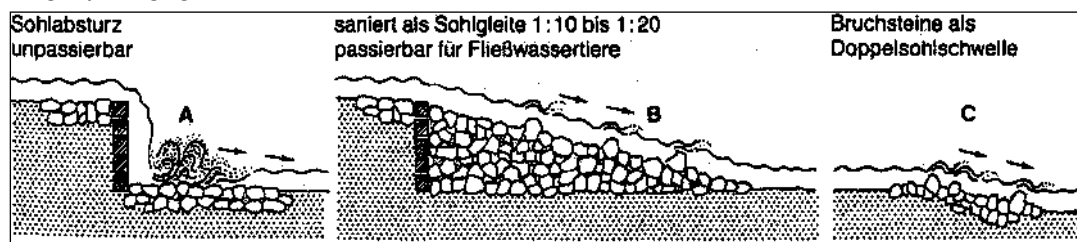
Abbildung 82: Anlage von Sohlgleiten
